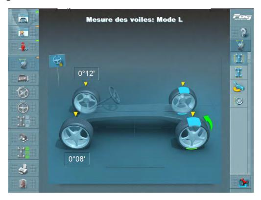
Par le terme voile, on désigne un mouvement oscillant de la roue en rotation. S'il n'est pas compensé, la mesure des valeurs de parallélisme et de carrossage risque d'être erronée.
