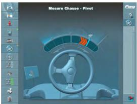
Dans le cas d'un réglage des carrossages et des chasses sur l'essieu avant, il est obligatoire de confirmer les valeurs de chasse et de pivot par une séquence de braquage (Voir écran ci-dessous). Ces nouvelles valeurs obtenues par mesure différentielle viennent s'inscrire dans la colonne « après réglage » du rapport de contrôle.
