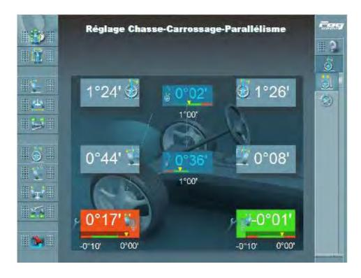
Le "Réglage de la chasse de l'essieu avant, véhicule levé" est affiché avec les valeurs mesurées suivantes :
