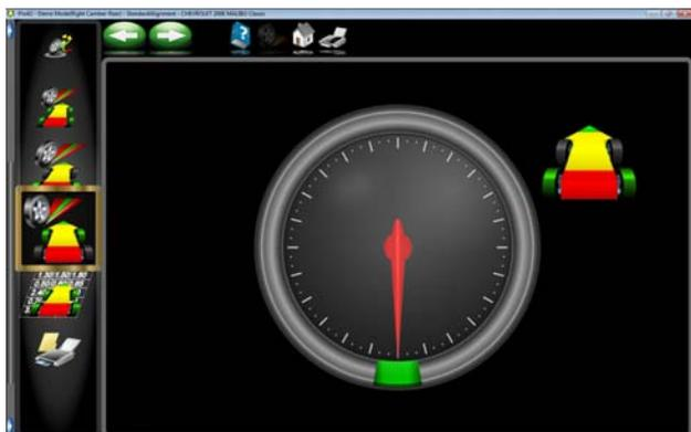
Rouler vers l'arrière avec les roues braquées de 180 degrés jusqu'au signal de stop.
