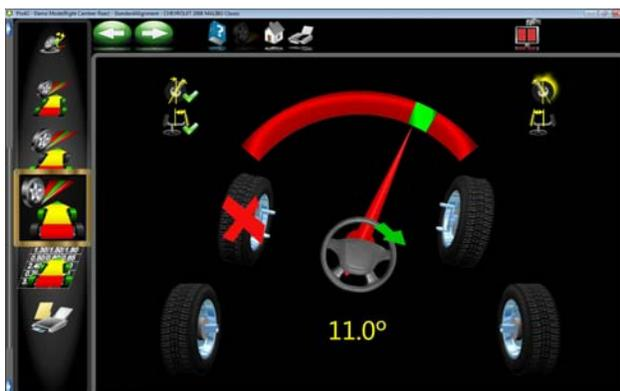
1. Que l'inclinaison de pivot soit mesurée sur les plateaux pivotants ou roues levées, les freins du véhicule doivent être absolument verrouillés. Démarrer la voiture pour activer les freins assistés, puis placer le presse-pédale de frein entre le siège et la pédale de frein.
