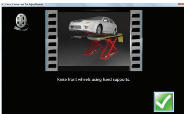
Cette fenêtre demande à l'opérateur de lever l'essieu qui doit être réglé
