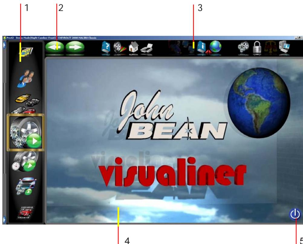
**1 - Commande Carrousel** - Sélectionner les fonctions de réglage principales à partir des icônes de défilement. Il est possible de faire défiler les icônes vers le bas ou le haut de la fenêtre de sélection à l'aide de la molette de la souris ou de la barre de défilement de Windows. Elles peuvent être sélectionnées en cliquant sur l'icône souhaitée avec le pointeur de la souris.
