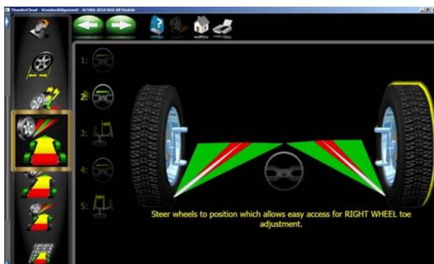
5. Dans la fenêtre suivante, un mètre précise le réglage nécessaire sur la roue droite pour corriger le parallélisme.
