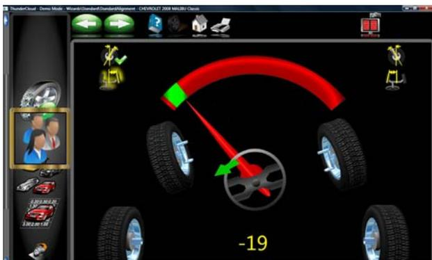
Alors que le volant tourne en pointant vers chaque position de mesure, l'indicateur vert en haut du compteur relève le mouvement de la roue. Les positions de mesure de l'angle de chasse et la SAI (valeur de compensation d'inclinaison) gauches et droites sont à environ  $+10^\circ$  et  $-10^\circ$ , alors que les positions d'ouverture dans les virages (TOOT) sont à environ  $+20^\circ$  et  $-20^\circ$ .
