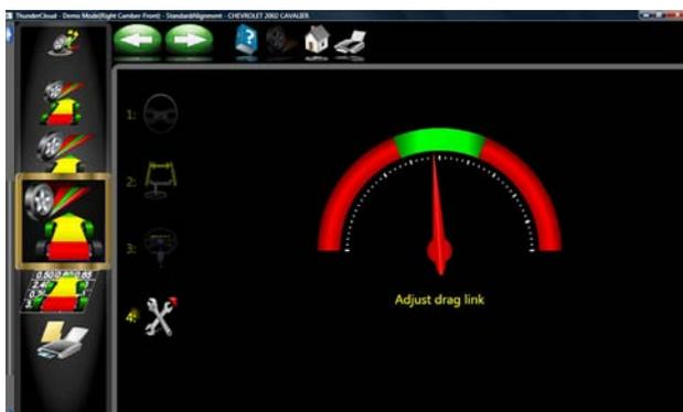
4. Ajuster la bague de la biellette pour mettre en ligne la direction, comme montré sur le mètre inférieur. Une fois l'opération terminée, cliquer sur Suivant.
