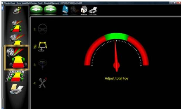
2. Ajuster le tirant simple selon les spécifications du parallélisme tout en observant le mètre supérieur. Cliquer sur Suivant.
