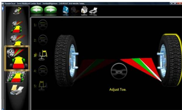
**REMARQUE :** si EZ Toe est utilisé avec un angle de braquage important, l'opérateur devra avoir recours au bloque-volant pour garder la tringlerie dans cette position.
