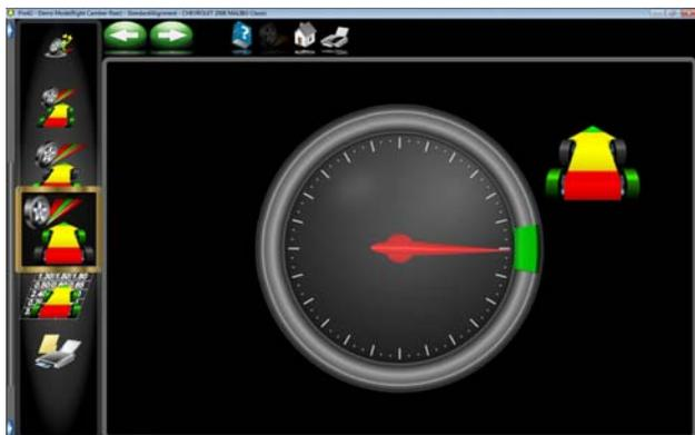
Rouler vers l'avant avec les roues braquées de 90 degrés jusqu'au signal de stop.
